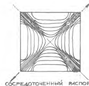
Рис. 2.9. Плоский крестовый свод. Модель напряженного состояния
