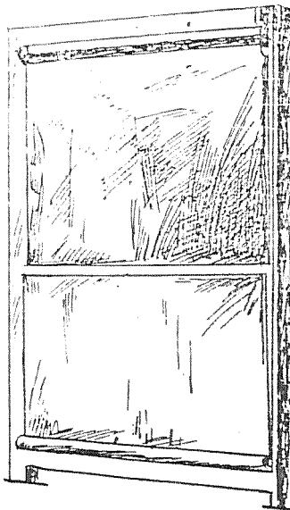
Рис.25. Регулируемое комбинированное устройство барабанного типа.
